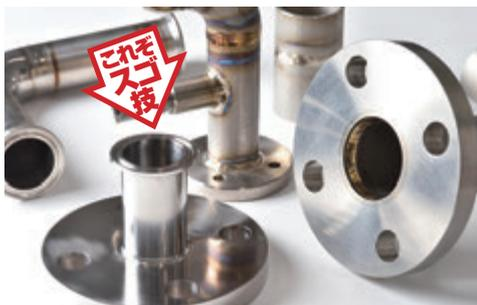
腐食や錆に非常に強く、食品や医薬品、半導体製造工場の配管などに使われるチタン、 Hastelloy、ジルコニウムなどの特殊材料の溶接技術を有する。溶接部分の酸化を防ぐ特殊な溶接治具を独自に開発し、丈夫で高品質な溶接加工が可能。
