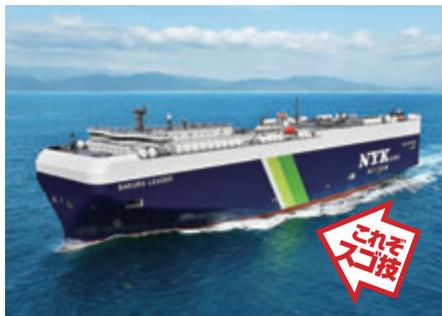
世界の自動車運搬船の建造において、約22%のシェアを占め世界トップクラスの実績を誇る。2020年には国内造船所で初となる大型LNG燃料自動車運搬船を建造し、独自開発の省エネ付加物を装備することで、CO2排出量を40%以上削減(2008年比)した。
