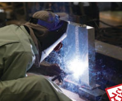
加工はもちろん取り扱いにもノウハウが必要な**大型アルミ製ブスバーの製造が可能であり、国内トップレベルの加工技術力**を誇る。溶接加工が難しい大型・厚物アルミ製品のオーダーに応えることができるのは、昭和30年代後半から専用の機器や技術が必要なアルミ溶接に特化した技術を追及し、他社との差別化を目指してきたことにある。
