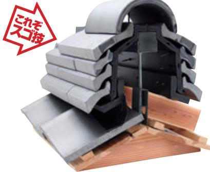
阪神・淡路大震災をきっかけに、日本建築における瓦屋根の耐震工法に取り組んできた当社が独自に開発した「耐震箱棟eeBOX」。従来の棟に使用していた土や漆喰を排除し、木製もしくは樹脂製のBOXに瓦を直接ビス打ちして固定することで強度と耐久性を確立。
