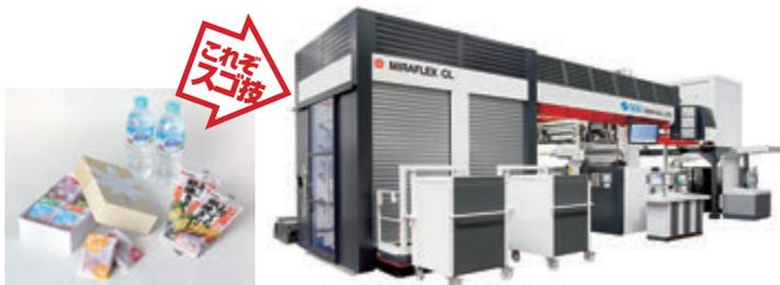
同社の軟包材への水性フレキシ印刷・加工は、インキ成分に有機溶剤 (VOC) をほとんど含まず、インキの塗布量もグラビア印刷の半以下。VOCを発生させないため燃焼処理が不要でCO<sub>2</sub>の排出を大幅に削減できる。
