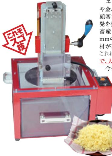
エンジニアリング会社として多彩な材質や金属の切断機械を設計・製作するなかで、顧客から実演販売用チーズスライサーの開発を委託される。試行錯誤の末、チーズ類、畜産・海産加工品、練り製品などを0.1~数mmの厚さにスライスし、透明な受け箱に食材が落下する小型フードスライサーを製作。これは目の前のパフォーマンスを「見る」ことで、大きな販促効果が得られるもの。今後新分野への展開も模索中だ。
