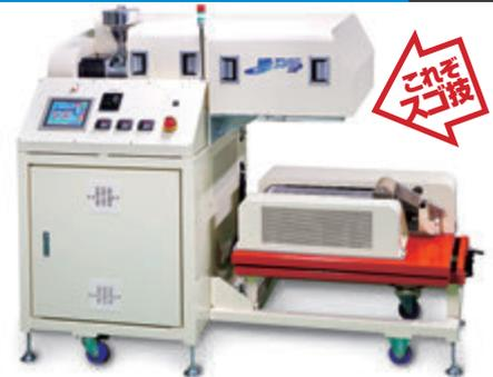
メルトブロー法とは、溶融した熱可塑性プラスチック樹脂を多数のノズル孔から吐出させ、高速の熱風により極細繊維化し、ネットコンベア上に吹き付けることでシート状にする不織布製造方法。
