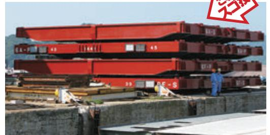
コンテナ船用のハッチカバーでは、日本一の生産量を誇るイワキテック。ボンツーンタイプ、ローリングタイプ、フォールディングタイプの3種類の自社ブランドの中でも、ボンツーンタイプ(コンテナ船用)は、生産量・質ともに高い評価を得ている。
