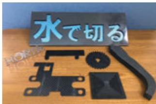
ウォーター切断によるCFRPの切断加工実績あり。ウォーター切断により炭化することなく切断面の品質が格段に向上します。
