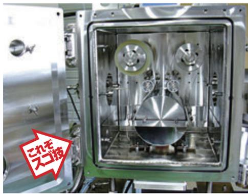
ロールツーロールで**プラスチックフィルム基板に金属薄膜を高速で形成**できる、コンパクトでエコミーマなスパッタリング装置を試作開発。これにより、フィルム走行系に工夫をすることで、PET等の耐熱性の低いフィルムにも高速成膜できる可能性を見出した。
