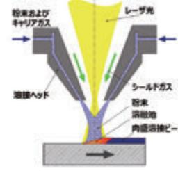
図1 レーザクラディングの概念図
