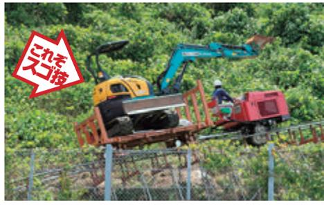
工法によって、環境を破壊することなく行える。また、製造しているすべてのモノレールには、排気ガス規制対応のエンジンを搭載。
