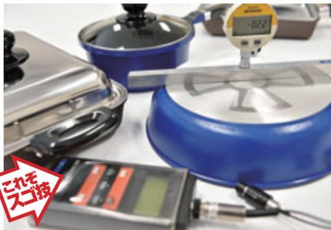
アルミ合金を金型に自然の重力で緩やかに一つひとつ流し込むアルミグラビティキャスト(重力金型铸造)製のアルミ鋼は、**基材の結晶構造が均一で熱ムラが少なく、変形にも強い**ため、付加価値の高い調理器具として高く評価されている。
