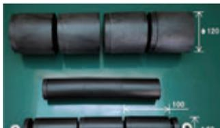
開発した軽量CFRPロール
