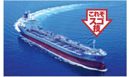
各種の液体化学物質、石油精製品などを運ぶケミカルタンカー。工作上管理が難しいとされるステンスタックを早くから採用し、「ケミカルタンカーの浅川」として業界に名を馳せる。
