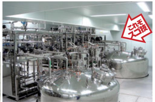
主に製業関係の注射用水設備、調製設備を取り扱っている。
