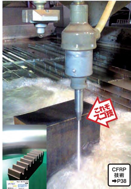
ウォーター切断は**高压の水で素材を切る**ため、アルミや銅、チタン、木、ステンレス、ゴム、セラミックのほか、複合材や張り合わせ材といった硬質軟質の複合多素材の切断ができる。複雑な形状の切断が可能であるだけでなく、切断時の熱影響がほとんどないので、**素材の変色や硬化など素材の変質を最小限度に抑えられる**。
