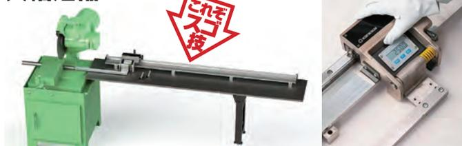
メジャーでは精度が出ない、ケガキ作業に時間がかかる、NC機はコストがかかりすぎる、という金属棒材切断の現場の声から誕生した手動式デジタル定寸器「デジビタット」。既存のメタルソーに取り付けるだけで**誰でも簡単に使え、切断加工精度と作業効率が格段にアップ**する。
