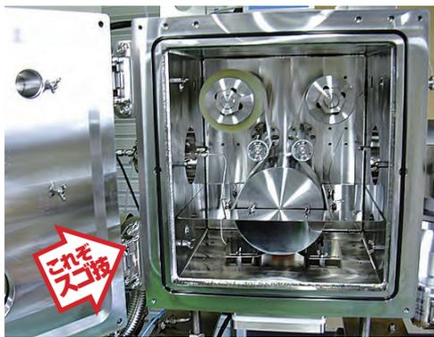
ロールツーロールで**プラスチックフィルム基板に金属薄膜を高速で形成**できる、コンパクトでエコミーマなスパッタリング装置を試作開発。これにより、フィルム走行系に工夫することで、PET等の耐熱性の低いフィルムにも高速成膜できる可能性を見出した。
