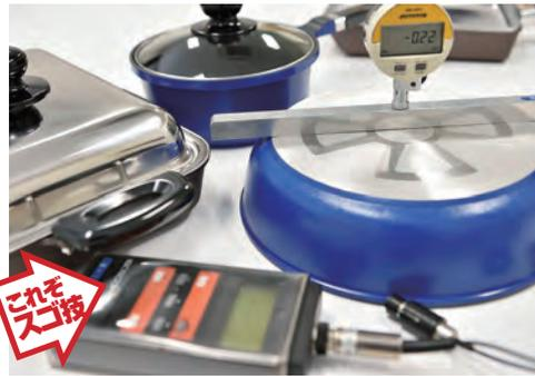
アルミ合金を金型に自然の重力で緩やかに一つひとつ流し込むアルミグラビティキャスト(重力金型铸造)製のアルミ鍋は、**基材の結晶構造が均一に熱ムラが少なく、変形にも強い**ため、付加価値の高い調理器具として高く評価されている。
