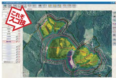
中山間直接支払制度の申請に必要な、集落協定図の作成、実施区域図の作成など、**傾斜測定から帳票作成までを一括管理**。簡易な操作で入力や管理にかかる労力を軽減。少人数での管理も可能で、人件費にかかるコストを削減できる。地図表示・検索、計測、入力、帳票出力までを**タブレット操作で完結できる**のも特長だ。現地を調査結果の登録・検索ができ、撮影した写真に位置情報がリンクしているため、事務所での写真と地図の照合作業が不要。労力とミスを削減できる。
