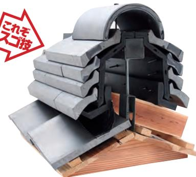
阪神・淡路大震災をきっかけに、日本建築における瓦屋根の耐震工法に取り組んできた当社が独自に開発した「耐震箱棟eeBOX」。従来の棟に使用していた土や漆喰を排除し、**木製もしくは樹脂製のBOXに瓦を直接ビス打ちして固定**することで強度と耐久性を確立。低コストで簡単に施工できる工法を追求し辿り着いた耐震箱棟eeBOXは、2016年の熊本震災後30棟以上の実績を上げている。**地震国・日本になくてはならない技術**として注目を集めている。
