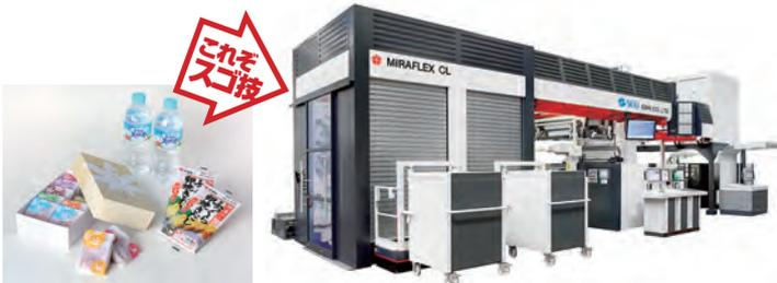
同社の軟包材への水性フレキシ印刷・加工は、インキ成分に有機溶剤(VOC)をほとんど含まず、インキの塗布量もグラビア印刷の半分以下。VOCを発生させないため燃焼処理が不要で**CO2の排出を大幅に削減**できる。
