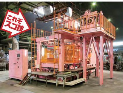
多様化する顧客ニーズに対応するために開発された**日本初の生産システム「Peach System Line」**。新造型機と模型取納車を組み合わせることにより、小ロット生産品の切り替え時の稼働停止“ゼロ”を実現。段取作業の自動化による製造を行い、短納期で高品質、低コストという難問を解決した。
