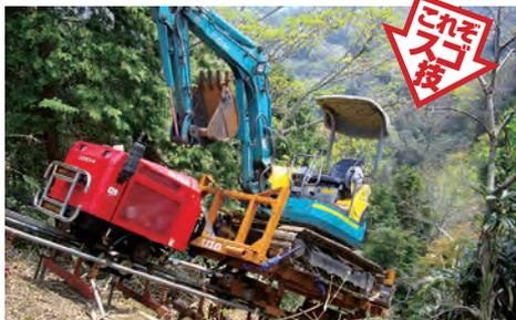
モノレールの設置には地形の制約が少ないので、電力、通信、土木、農業、林業など、傾斜地での運搬の効率化・省力化に最適。
