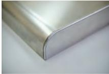
エネルギー効率が高く、高出力が可能、ビーム品質に優れ安定性が高いことなどからレーザー加工の主流となっているファイバーレーザー溶接技術。同社は一般的には精密板金分野に導入実績が多い同技術を、**大型板金加工を中心とした一般製備品の溶接分野に適用。4mの走行台車を付属したロボット搭載システムにより、多品種少量から量産品まで幅広く対応する。**低歪みかつ深い溶け込みの溶接、反射材にも適用可能な溶接により、板金分野のものづくりの常識を大きく変える可能性を秘めた技術である。
