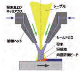
図1 レーザクラディングの概念図
