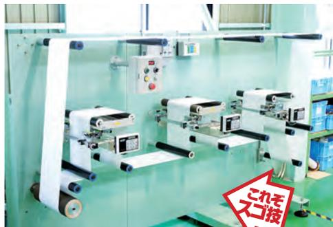
生産工場で人間の手に変わる機械を、一貫した総合設計で生産。圧倒的な提案・仕上げ・サポート力でパーフェクトなFA機器を届けている。特に**サニタリー製品の生産ラインには欠かせない蛇行修正装置HAW**は、メンテナンスフリーで壊れない、操作性が高くセッティング時間も短縮できることなどから、圧倒的な国内シェアを誇る。これら同社の製品を支えているのは、部品製造や金属加工など30数社の協力会社で構成される「WinWin会」である。
