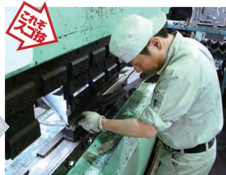
強みは精密板金。なかでもプレーキプレス機でのポッター加工は**プレス加工しながら、滑らかな表面Rと高い真円度の加工が可能**なこと。規格にないレジャーサー等、円錐形のテーバー加工だけでなく、多角形から丸形への角丸加工も高い精度で曲げる加工ができるとの評判を得ている。
