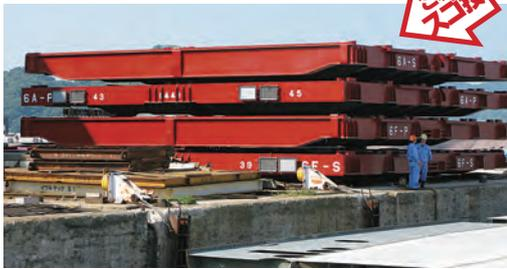
コンテナ船用のハッチカバーでは、日本一の生産量を誇るイワキテック。ボンソータイプ、ローリングタイプ、フォールディングタイプの3種類の自社ブランドの中でも、ボンソータイプ(コンテナ船用)は、生産量・質ともに高い評価を得ている。
