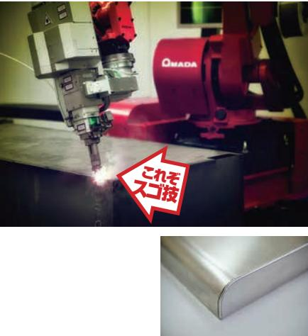
エネルギー効率が高く、高出力が可能、ビーム品質に優れ安定性が高いことなどからレーザー加工の主流となっているファイバーレーザー溶接技術。
