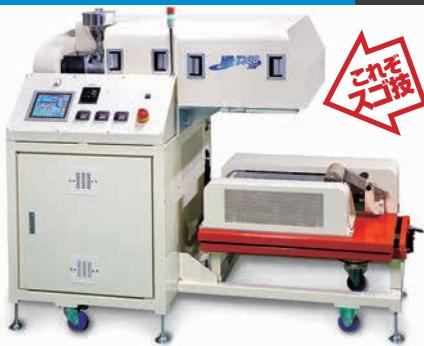
メルトプローフ法とは、溶融した熱可塑性プラスチック樹脂を多数のノズル孔から吐出させ、高速の熱風により極細纖維化し、ネットコンベー上に吹き付けることでシート状にする不織布製造方法。
