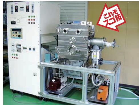
ロールツーロールで**プラスチックフィルム基板に金属薄膜を高速で形成**できる、コンパクトでエコノミーなスパッタリング装置を試作開発。これにより、フィルム走行系に工夫をすることで、PET等の耐熱性の低いフィルムにも高速成膜できる可能性を見出した。
