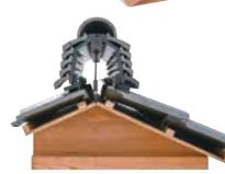
阪神・淡路大震災をきっかけに、日本建築における瓦屋根の耐震工法に取り組んできた同社が独自に開発した「耐震箱棟eeBOX」。従来の棟に使用していた土や漆喰を排除し、木製もしくは樹脂製のBOXに瓦を直接ビス打ちして固定することで強度と耐久性を確立。
