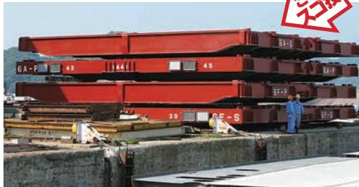
コンテナ船用のハッチカバーでは、日本一の生産量を誇るイワキテック。ポンツーンタイプ、ローリングタイプ、フォールディングタイプの3種類の自社ブランドの中でも、ポンツーンタイプ(コンテナ船用)は、生産量・質ともに高い評価を得ている。
