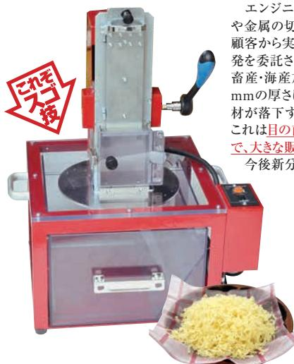
エンジニアリング会社として多彩な材質や金属の切断機械を設計・製作するなかで、顧客から実演販売用チーズスライサーの開発を委託される。試行錯誤の末、チーズ類、畜産・海産加工品、練り製品などを0.1~数mmの厚さにスライスし、透明な受け箱に食材が落下する小型フードスライサーを作製。これは目の前のパフォーマンスを見ることで、大きな販促効果が得られるもの。
