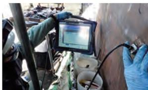
主に製鉄や石化プラントの重要設備において、PAUTを用いた調査・診断サービスを適用しており、溶接線や部材、軸製品などの割れ検査や減肉調査などを実施している。陸上風力発電向けでは、ヨーギアの検査やタービンローター主軸、タワー締結ボルトの割れ検査での適用実績がある。
