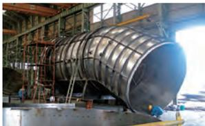
石炭火力発電所などのボイラー排ガスから硫黄酸化物(SOx)を取り除き、浄化するための排煙脱硫装置における脱硫ダクトを製作。新規事業として、特殊鋼材(ハステロイ等)を用いた大型スクラパー等の製作にも注力している。
