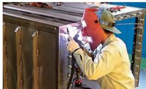
薄板での溶接構造気密容器の加工レスを実現。機械加工を省略し、職人の手仕上げでガスシール面を平滑に仕上げる技術を確認した。機械加工の工程が減ることにより、低コストを実現。サイズや仕様に応じて部分的に機械加工、加工レスを組み合わせることも可能。
