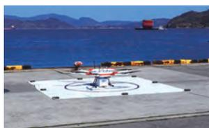
長時間飛行可能なドローンの開発実績が評価され、SBIR実証プロジェクトに採用された。国土交通省のオーダーを受け、山間部においても長時間かつ降雨下で飛行可能な機体の開発に臨んでいる。最終的には2kg積載し、山間部降雨下で80分以上の飛行をめざす。
