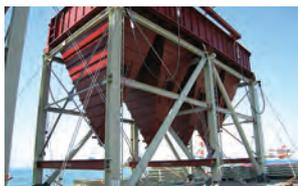
発電プラントの排煙に含まれるダイオキシンを除去し、クリーンな空気を排出する大型集塵装置を製造。大型加工設備を備えた本社工場と2つの関連工場により、効率的かつ精度の高い集塵装置を実現している。
