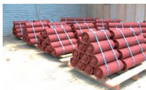
フランジの製造技術を応用し、LPガスボンベメーカー（萩尾高圧容器株式会社）と共同でベルトコンベアローラを開発。軸受部をプレス成形した金属カバーで密閉し一体化構造とすることで、約3割のコストダウンと製品寿命の2倍増を実現した。意匠登録、特許ならびに国際特許を取得。
