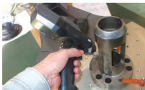
より信頼性の高い機械装置製造のため、それを構成する部品の精度を上げる事が求められる。作業者の経験の差による検査技術のばらつきを平準化するとともに、作業効率の向上にも繋がるよう三次元測定機を導入している。
