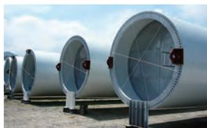
長さ約70mの陸上風力発電用支柱を3分割で製作し、現地にてボルト接合。縦型旋盤により鍛造フランジの加工、NC鋼板切断機にてV開先を自動で切断、円錐曲げや溶接、塗装など全工程を自社設備内で実施。フランジの平面度、垂直度の精度において高評価を得ている。
