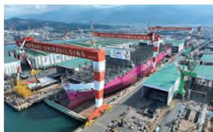
24,000TEU型超大型コンテナ運搬船((L)399.95m×(B)61.4m×(D)33.2m、総トン数:235,311t)“ONE INFINITY”がシップオブザイヤー2023を受賞。風による抵抗増加を減らすと同時にコンテナ積み個数を増加させた新船首風防の新規性などが高く評価された。
