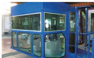
運転室は、ガラス、クロス、エアコンやコントローラーの設置、電気配線まですべて同社で施工し納入する。オペレーターに実際の運転室を確認してもらい、ミリ単位の調整まで要望に柔軟に応じ、それぞれにとっての最適・快適を追求したオーダーメイド運転室を提供する。
