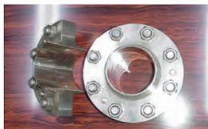
同社が開発したNOSフランジは、フランジと単管を一体化した鍛造型構造体。溶接を不要としたことで熱歪によるトラブルを回避できる。国内製紙会社の多くで使用され、配管内の溶剤の漏れや堆積の発生を防ぎ、製造ラインの安定を維持すると同時に部品コストの削減も叶える。
