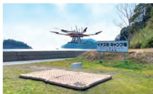
島しょ部の過疎地域における課題解決を目的とした物流実証実験。今治市波方港から大三島までの片道直線距離8kmを、最大5kgの荷物を載せて飛行することに成功。波方港で遠隔操作を行い、離陸から荷物の投下、着陸まですべて自動運行を実現。一度も充電することなく往復16kmを飛行した。
