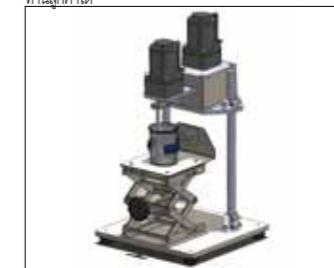
อุปกรณ์การกวนที่ใช้การหมุนแบบเอียงศูนย์เป็น 2 แกน (Bi-axial Eccentricity Stir)
